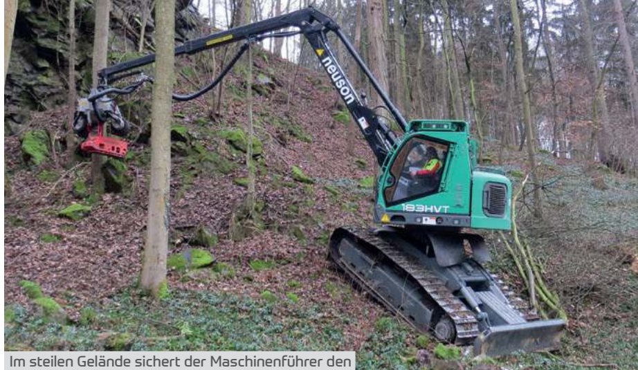
Im steilen Gelände sichert der Maschinenführer den Raupenharvester mit dem Schild
