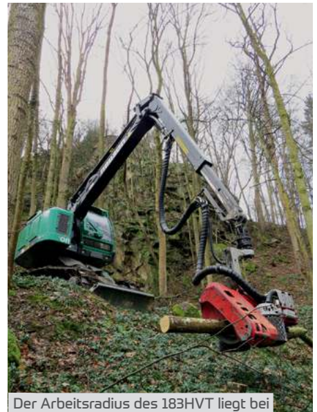
Der Arbeitsradius des 183HVT liegt bei 360° am Stand
